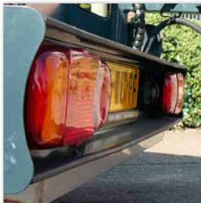
Integrierte Beleuchtungseinheit, in Stoßstange geschützt
