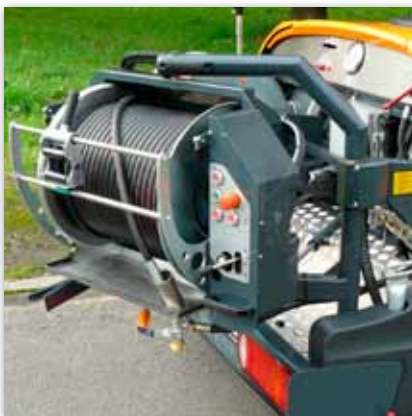
Vollständig stufenlos und hydraulisch bedienbare 270° drehbare HD Haspel (verriegelbar in jedem Winkel)
