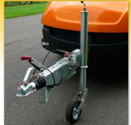
Stützrad, vollautomatisch klappbar, erschwert und dauerhaft
