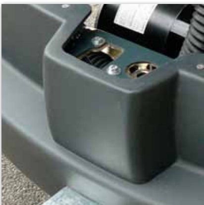
Verriegelung der Motorhaube mit Entriegelungshebel im Staukasten
