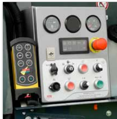
Steuerschrank / Elektronik in abschließbarem, gegen Vandalismus und Wasser beständigen Staukästen
