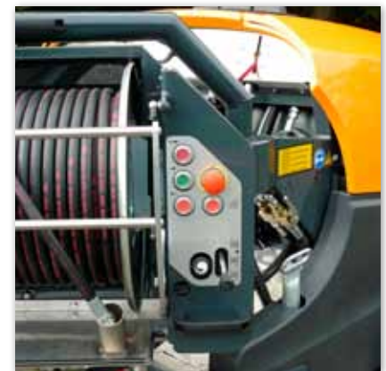
Mitdrehende Schalttafel neben der HD Haspel; montiert auf ergonomischer Arbeitshöhe
