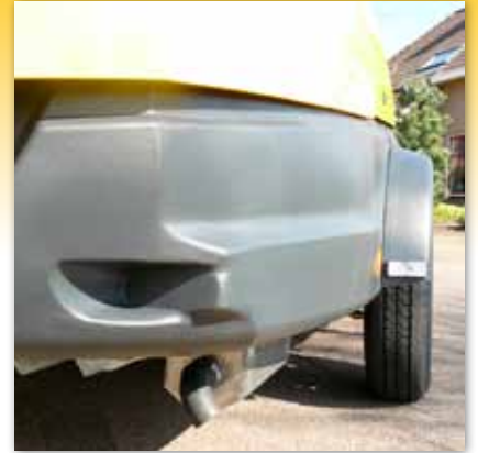
Stoßfeste Abdeckungen und Seitenplatten; Kratzer / Risse einfach zu reparieren
