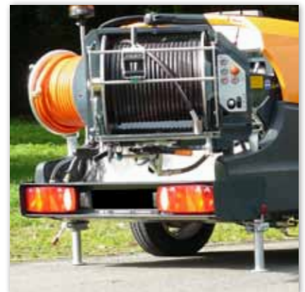
Stützen; zusätzliche Sicherung zugunsten dem hydraulischen Aufhaspeln des HD-Schlauchs
