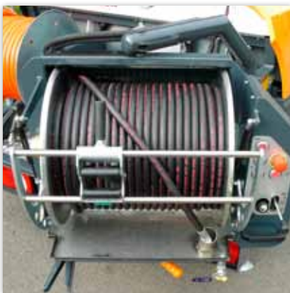
Mitdrehende Edelstahl-Auffangwanne verhindert das Verschmutzen der Maschine
