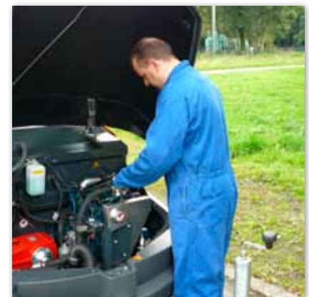
Abschließbare Motorhaube mit großem Öffnungswinkel; ideal für Inspektion/ Instandhaltung am Motor- / Pumpenkompartiment
