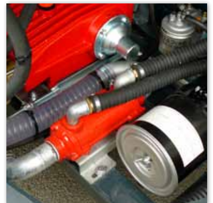
Zuverlässige Motortemperaturkontrolle mittels Wärmetauscher
