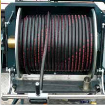
ROM Rohreinigungsschlauch in 1/2" Ausführung (bis 120m. möglich)
