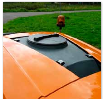
Polyethylen-Wassertank; Deckel mit Schnellverschluss
