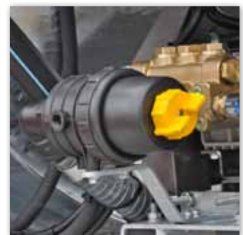
Automatisch schließender Wasserfilter mit waschbarem Element
