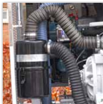
kombinierter Ölabscheider / Geräuschdämpfer (Version V-140/60)
