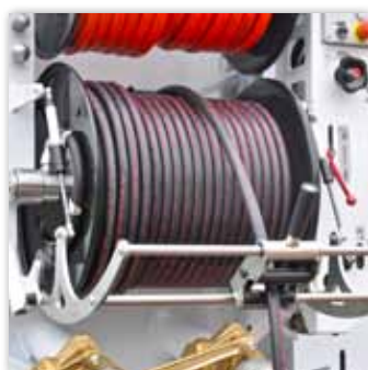
Hydraulischer Antrieb von HD Haspel mit u.a. ausklappbare gelagerte Schlauchführung
