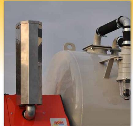
Aktiv Kohlefilter für Luftfiltration und Lärmdämpfung
