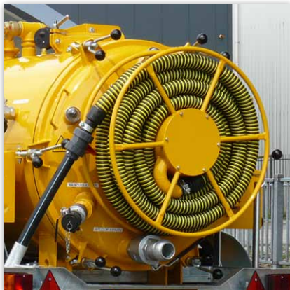
Vakuumschlauchhaspel + 18m. Vakuumsaugschlauch 2", Saugrohr mit Kugelhahn
