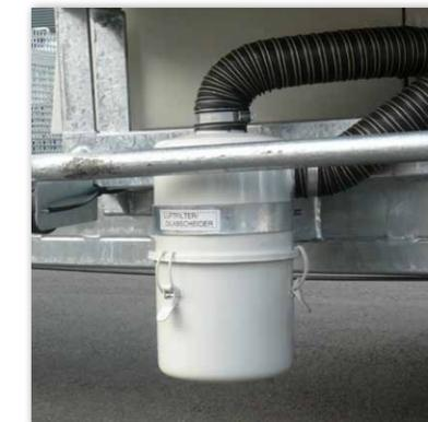
Kombinierter Ölabscheider/ Abgasschalldämpfer
