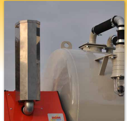
Aktiv Kohlefilter für Luftfiltration und Lärmdämpfung
