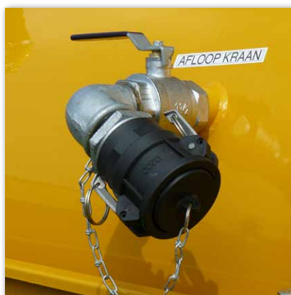
Abflusshahn für Abfluss von Wasser, Zirka 2/3 des Abwasserbehälters
