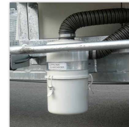
Kombinierter Ölabscheider/ Abgasschalldämpfer
